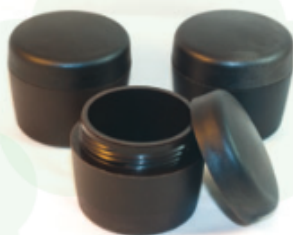
Prototypni vzorci kozmetične embalaže iz novega biokompazitnega materiala na osnovi PLA in citrusov vlaknen.
